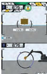
Además, una vez que una excavadora convencional se ha equipado con el **Sistema de Guiado 3D** de Komatsu, los operadores ya no necesitarán referenciar nuevamente la máquina cada vez que la cambien de ubicación. Mediante los diferentes sistemas globales de navegación por satélite (GNSS), se puede determinar con precisión la ubicación de la máquina y conocer cuál es la superficie
