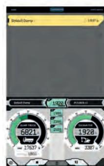
Por otra parte, el medidor de carga útil ayuda también a prevenir la sobrecarga de camiones al facilitar que los pesos cargados sean los adecuados para vehículos de carretera y fuera pista, reduciendo el riesgo de dañar el equipo y otros peligros relacionados con el exceso de carga.
