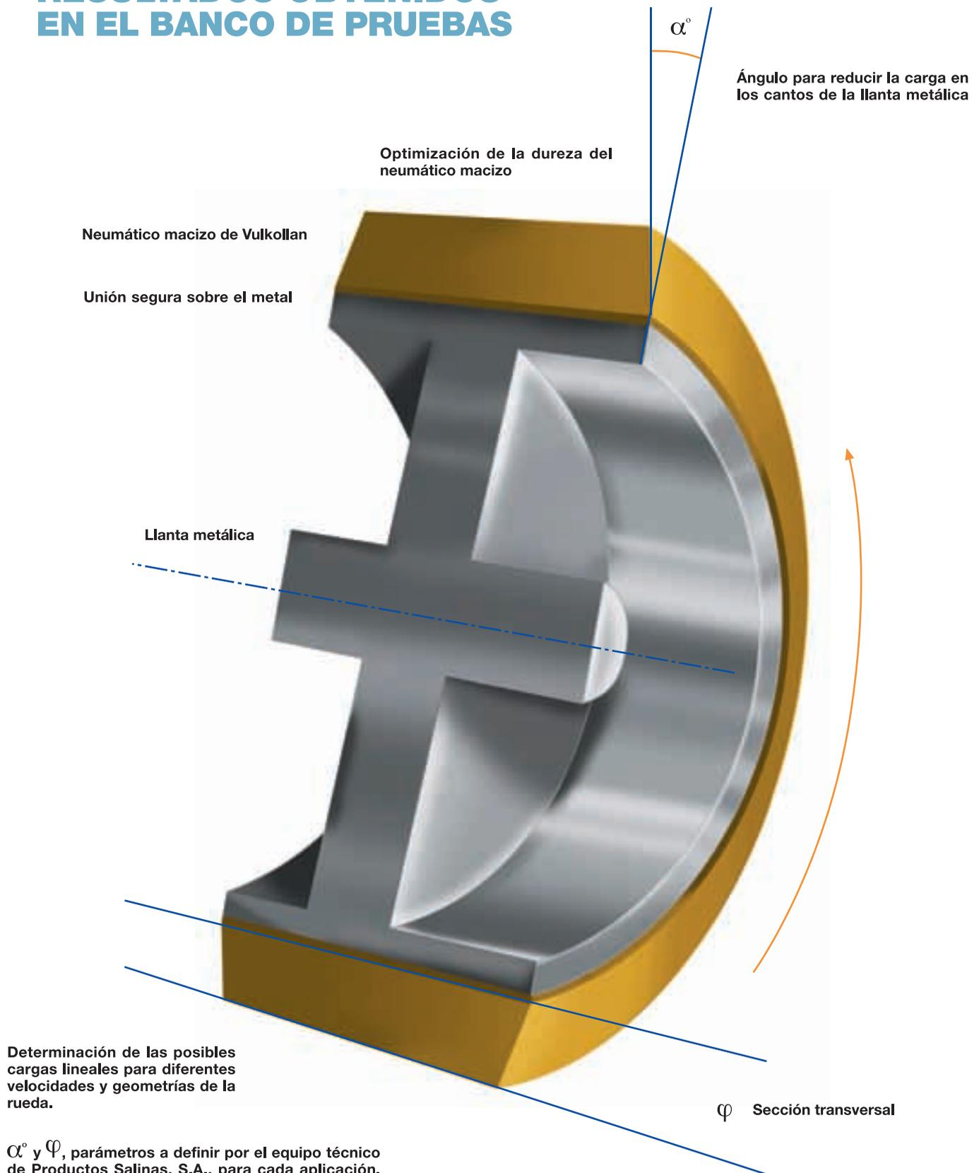
Los rodillos y ruedas, campos importantes para la utilización del poliuretano, se someten a todo tipo de esfuerzos. En el banco de pruebas puede determinarse el comportamiento de los materiales en esfuerzos dinámicos.
