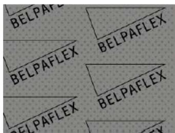
Plancha consistente en dos laminas libres de amianto ensambladas en una lámina de acero perforada. Alta resistencia a temperaturas en juntas de culata y tubos de escape de motores de gasolina y diesel así como buena resistencia a aceites, fuel y fluidos refrigerantes. Material para juntas para la industria de la automoción.
